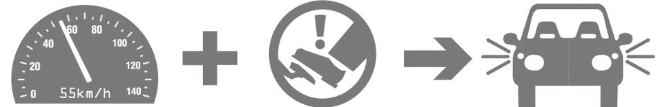
※緊急制動表示(ESS)機能は55km/h(±3km/h)<sup>\*1</sup>以上での走行時に9m/s<sup>2</sup>より大きな減速を検出した場合に動作します。また自動点滅機能は3Hz(毎分180回)の早い点滅を行い、減速の度合いが3m/s<sup>2</sup>になった時点で急点滅は自動停止します。(※1. 車両の重量などの条件により変化します。)
