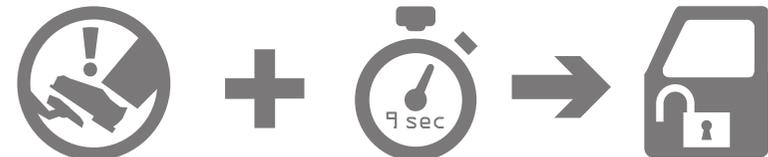
※本製品に搭載されている緊急時アンロック機能は急激な減速を検出してから9秒後にドアをアンロックします。急ブレーキや急停車など実際の衝突が発生しない場合でも規定以上の減速を検出した場合にはドアをアンロックします。(エアバッグの動作とは連動しません)。ただし、急減速を検出してから9秒後の時点で車両速度が20km/h以上の場合は一旦アンロックしすぐにロックします(車両によってはまったくアンロックされない場合があります)。
