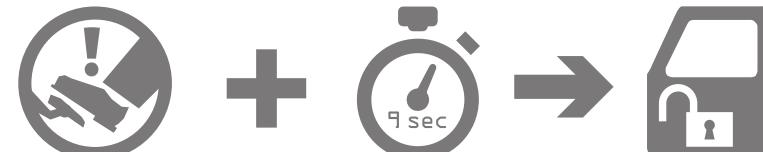
※本製品に搭載されている緊急時アンロック機能は急激な減速を検出してから9秒後にドアをアンロックします。急ブレーキや急停車など実際の衝突が発生しない場合でも規定以上の減速を検出した場合にはドアをアンロックします。(エアバッグの動作とは連動しません)。ただし、急減速を検出してから9秒後の時点で車速が0km/hでない場合にはアンロックしません。
